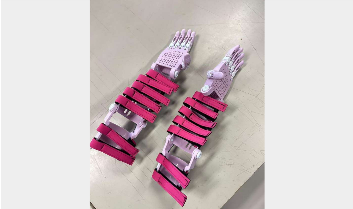
Prótese de mãos feita em impressora 3D — Foto: IESB/Divulgação
